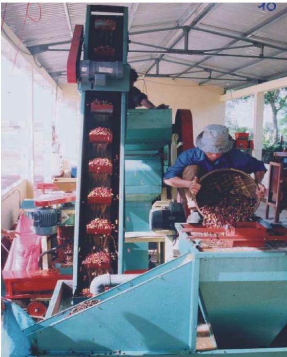
Bể xi phông và gàu tải cấp liệu máy LXT 1500
