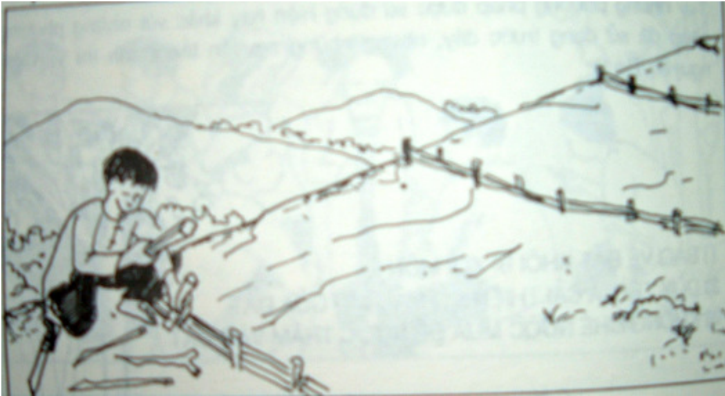
Hình 1-33. Rào chắn xói mòn đất làm bằng cọc tre
