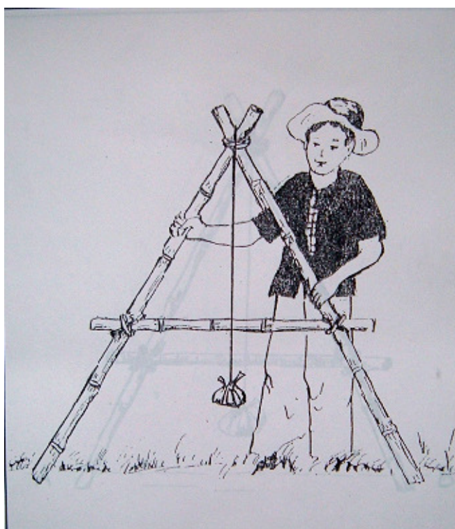
Hình 1-24. Các thanh gỗ hoặc tre đã được buộc thành khung chữ A
