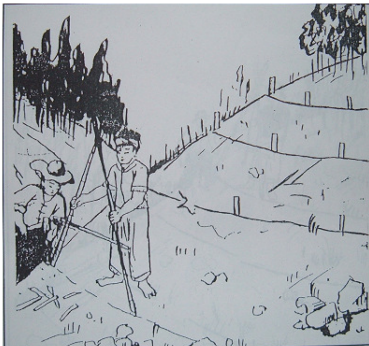
Hình 1-28. Đường đồng mức được xác định bằng khung chữ A
