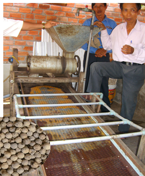
H28: Máy xát vỏ hạt tiêu sau khi ủ và tiêu trắng thành phẩm
